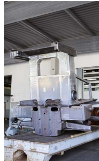
Heckrahmen mit „Rops“ eines Müllverdichters kurz vor dem Lackieren
