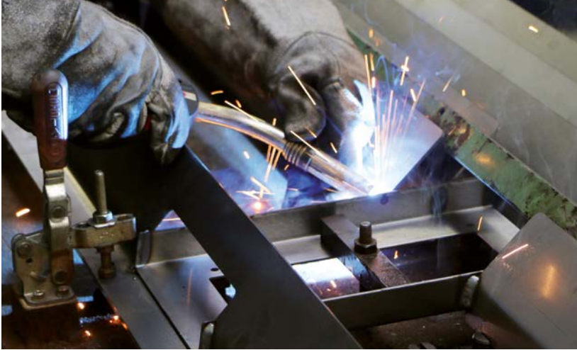
Aus Dünnsblech geschweißte Heckklappe für 55 Tonnen Müllverdichter
