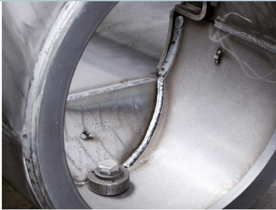
Detailansicht geschweißter Heckrahmen für den BOMAG Walzenzug BW 213 DH
