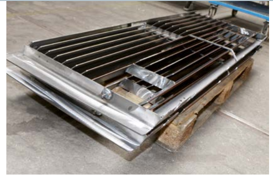
Aus Dünnsblech geschweißte Heckklappe für 55 Tonnen Müllverdichter
