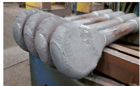
Stau- geschmiedete Rundstahlanker
