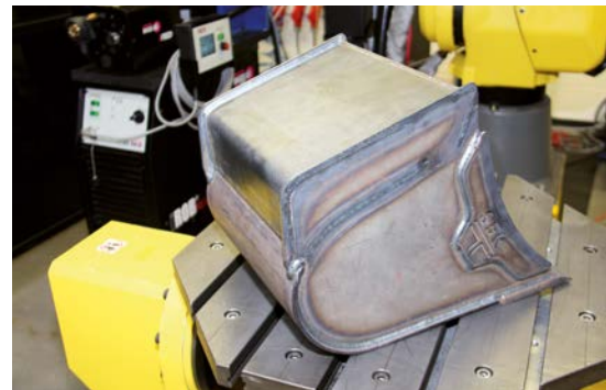
Durch Optimierung automatisiert geschweißter Baggerlöffel
