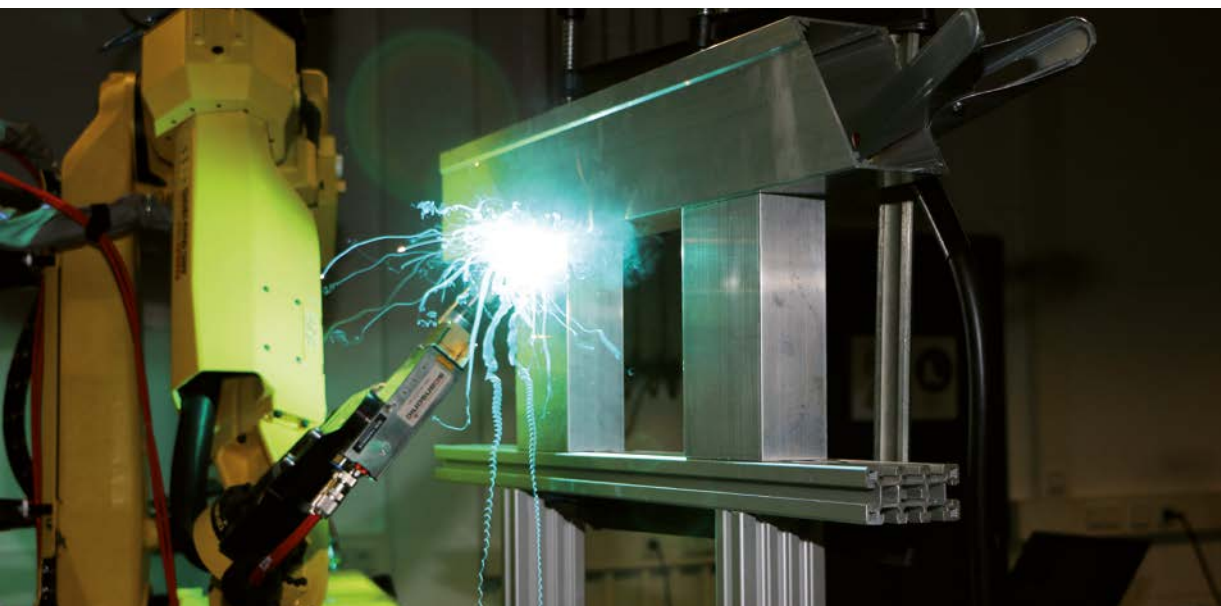
Über-Kopf-Schweißen von Aluprofilen im Doppel-Puls-Verfahren
