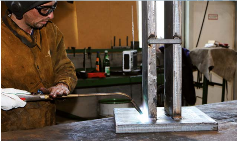
Vorwärmen des T-Anschlussstückes
