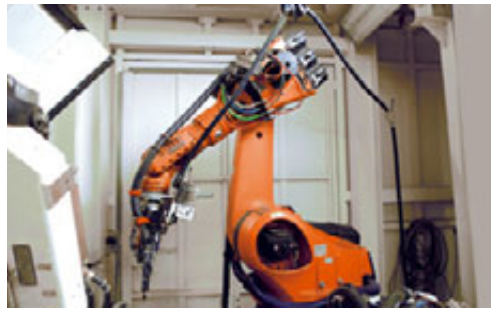
Komplettes System an Roboter mit speziellem Drahtförderschlauch.
