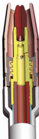
Ein luftgekühlter Brenner der ABIROB®-Serie im Schnitt.
