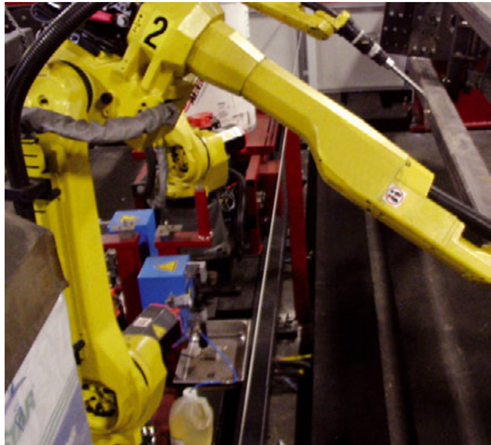
Automatisiertes Schweißen von Stahlträgern – eine typische Anwendung in der Transportindustrie.
