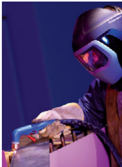
Plasmaschneidbrenner ABICUT, luftgekühlt – die Verbindung von optimalem Handling und hoher Schnittqualität.
