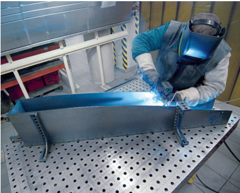
Handschweißarbeitsplatz zur Lösung vielfältiger Schweißaufgaben bei Baugruppen in Kleinserien
