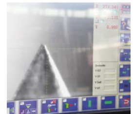
Feinjustieren des TCPs direkt am Montagearbeitsplatz
