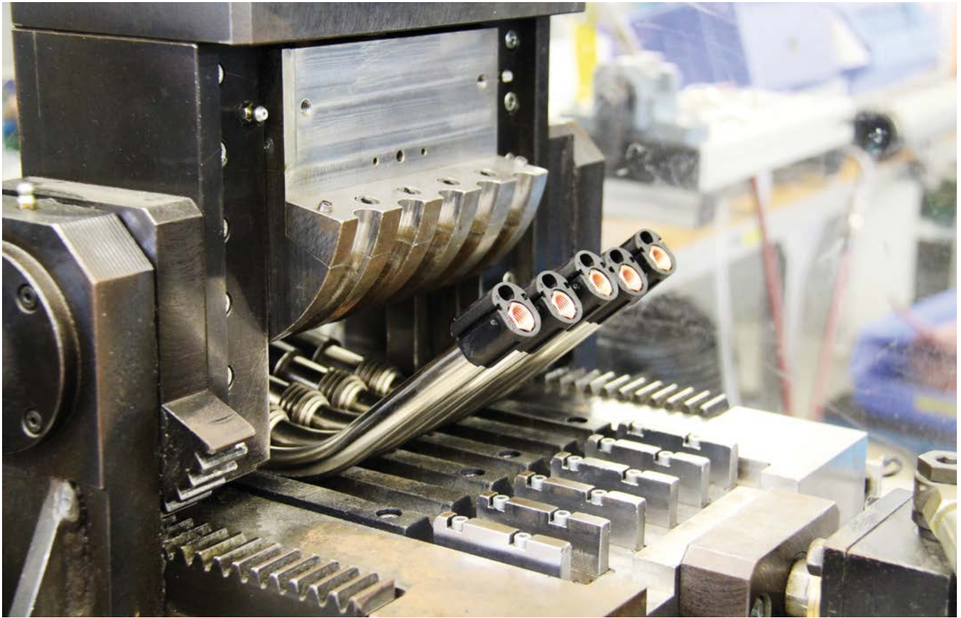
Fünffach Brennerhals-Biege- maschine in der Baugruppen- montage bei der KURT HAUFE Schweißtechnik
