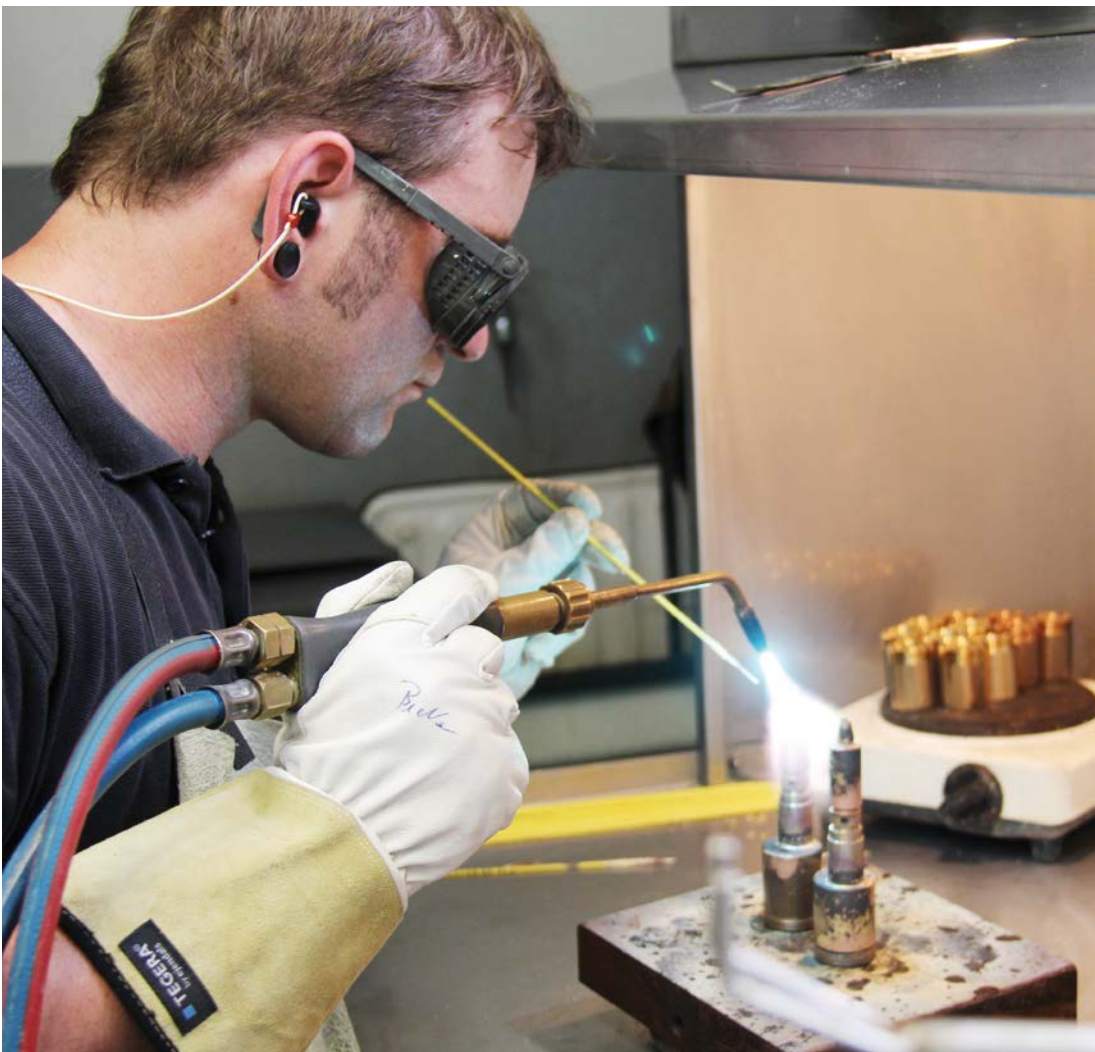
Manuelles Hartlöten in der Löterei der KURT HAUFE Schweißtechnik
