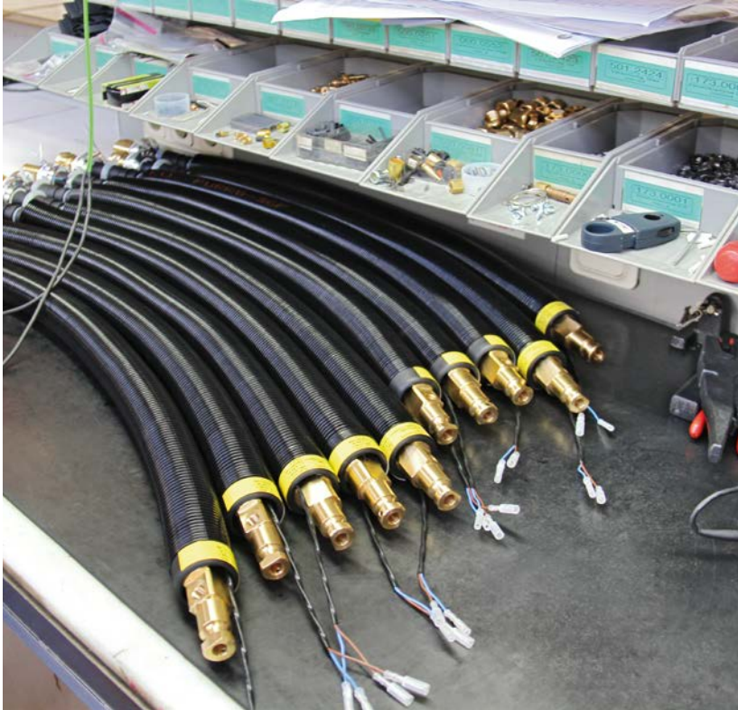
Konfigurierte Roboterbrenner- schlauchpakete
