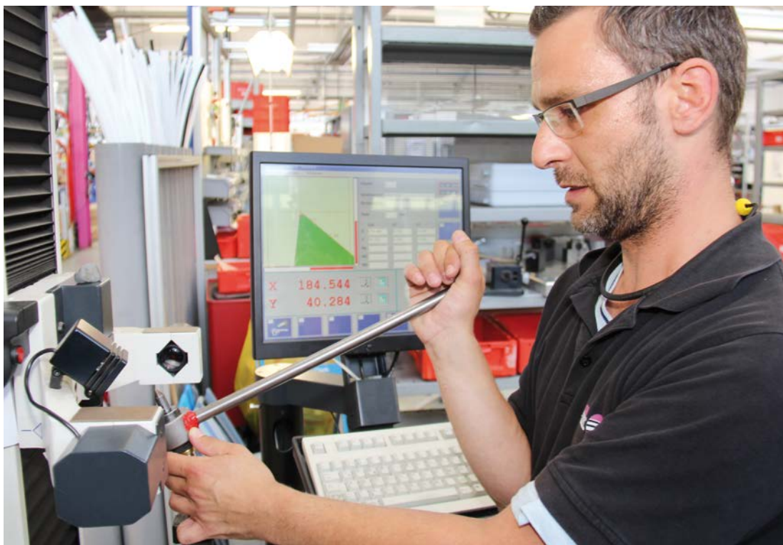
Feineinstellung des Arbeitspunktes (TCP) von Roboterbrennerhälsen
