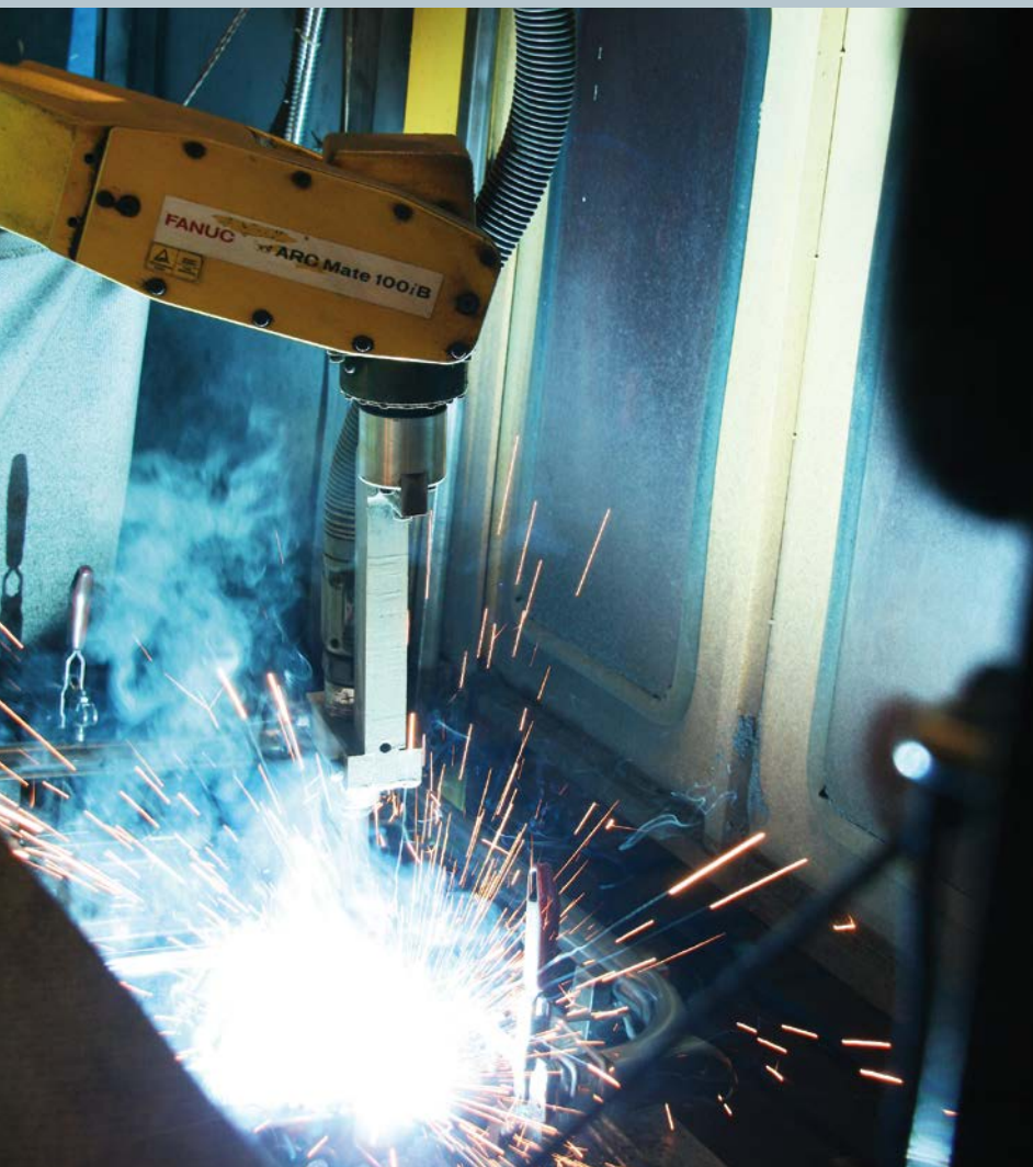
Luftgekühlter ABIROB® A360 Brenner von ABICOR BINZEL in Aktion in einer Schweißzelle bei Assan Hanil
