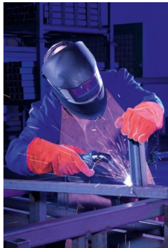
RAB GRIP-Brenner mit Absaugung durch FES-200
