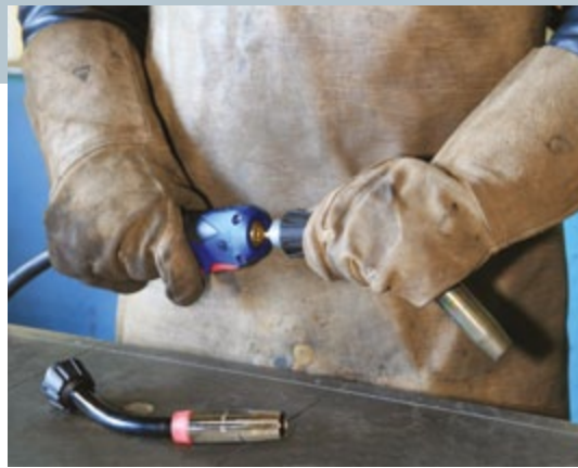
Wechsel des Brennerhalses innerhalb kürzester Zeit
