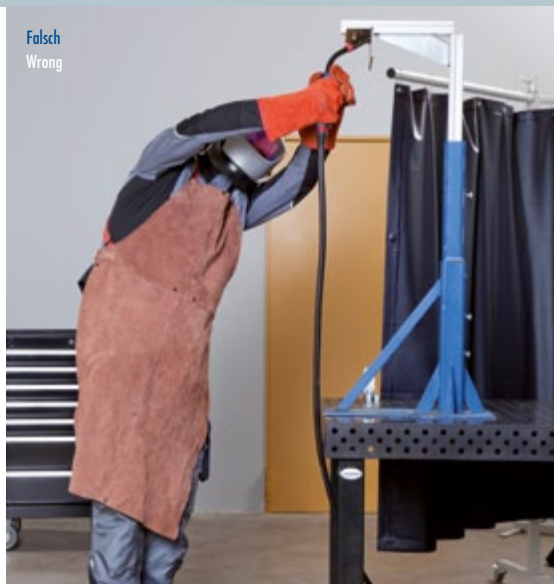
Die richtige Arbeitshaltung sorgt für weniger Belastung – besonders beim Über-Kopf-Schweißen
