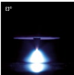
Weniger thermische Belastung, geringerer Abbrand - E3 ® -Elektrodenspitze im Vergleich zu WTh 20.
