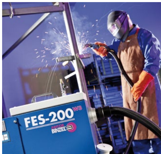
RAB GRIP Brenner mit Absaugung durch FES-200
