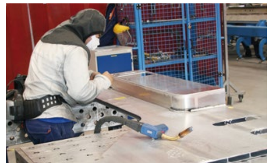
Schweißarbeitsplatz ausgestattet mit ABICOR BINZEL Push-Pull Plus Brenner
