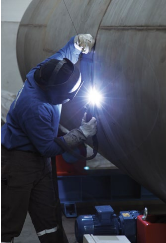
Verschweißen von Behältern mit dem WIG-Schweißverfahren
